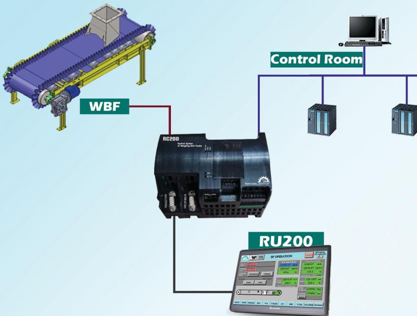
بالت فیدر ترکیبی است از یک فیدر نواری، یک توزین دینامیک و یک کنترلر مرکزی که وظیفه آن تغذیه مواد دانه بندی شده به کوره می باشد.
